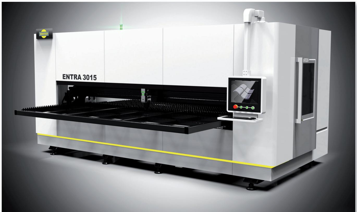
De ENTRA-3015 is een lasersnijmachine met standaard een uitschuifbare snijtafel aan de lange zijde. Het beladen en ontladen kan zo ongestoord van 4 zijden gebeuren. De gesloten behuizing zorgt er voor dat het snijden perfect veilig kan gebeuren.
